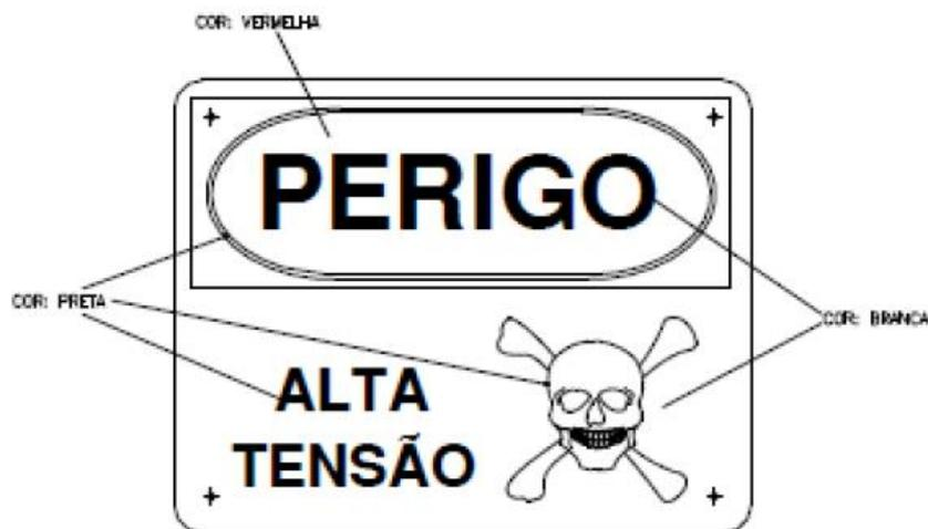
As placas devem ter fabricação em aço nº16 e os campos / legendas pintadas em face única, com o emprego da técnica de impressão em SERIGRAFIA (evitando corte mecânico do vinil adesivo). Com a finalidade
